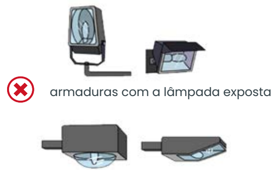
armaduras mal direcionadas
